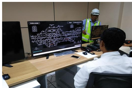
新：電子連動装置（制御端末 日本製）
